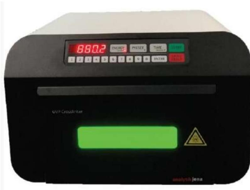
紫外交联剂 CL-3000 用于测量和控制曝光室内的紫外线（UV）辐射。独特的紫外线传感器可连续测量紫外线能量，并自动适应随着紫外线灯管老化而发生的紫外线强度变化。使用相同的紫外线传感器反馈测量系统，您可以设置紫外线样品的曝光量，当达到设定的紫外线能量剂量时，该机器会自动停用紫外线辐照。
